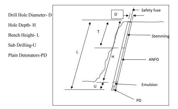
Figure - 6. Blast hole parameters
